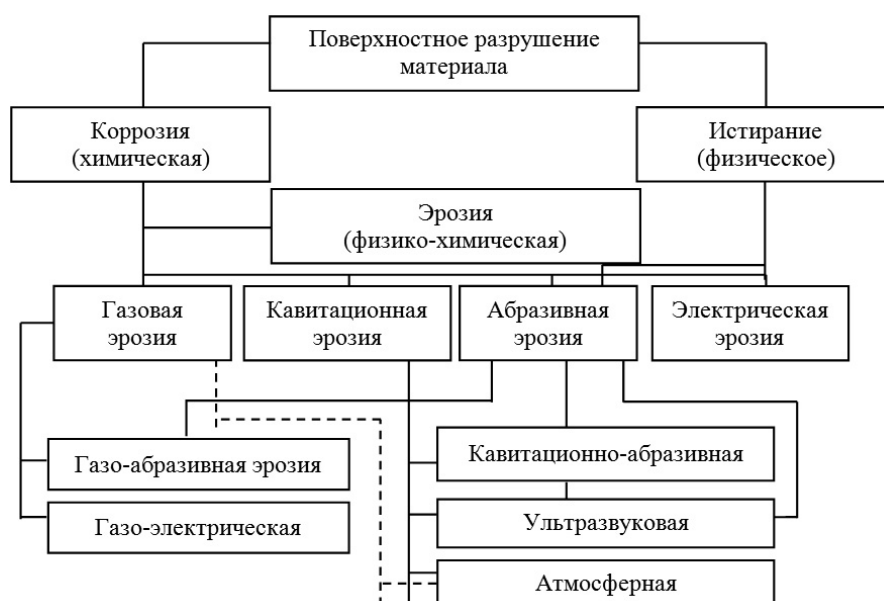
Рисунок 1. Схема классификации видов эрозионного разрушения материалов
