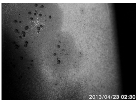
Рисунок 5. Ударное воздействие капель на поверхность лопаток 22 ступени РСД
